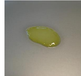
Kleur na 3 – 5 minuten bij aanwezigheid van molybdeen (ter indicatie)
